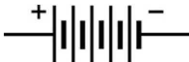
Rysunek 3.51. Symbol zamkniętej baterii elektrochemicznej składającej się z wielu ogniw
