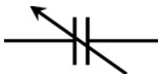
Rysunek 3.12. Standardowy symbol kondensatora nastawnego, bez rozróżnienia statora i rotora
